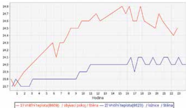
Průběh denní teploty v přetápěném bytě, regulace otopné soustavy funguje dle poklesu teploty v nočních hodinách
