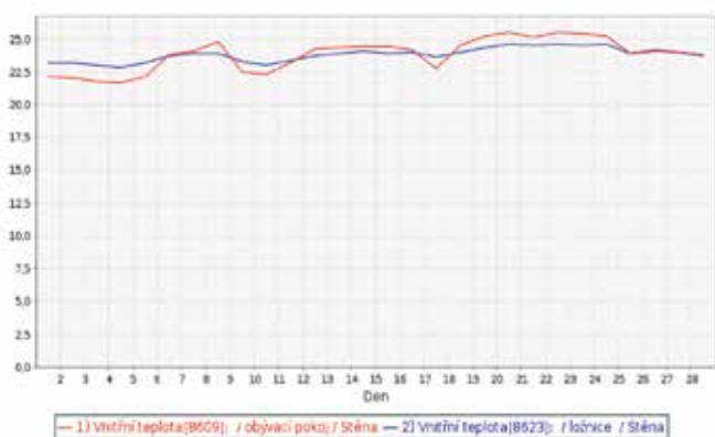
Průběh teploty v přetápěném bytě během února 2015
