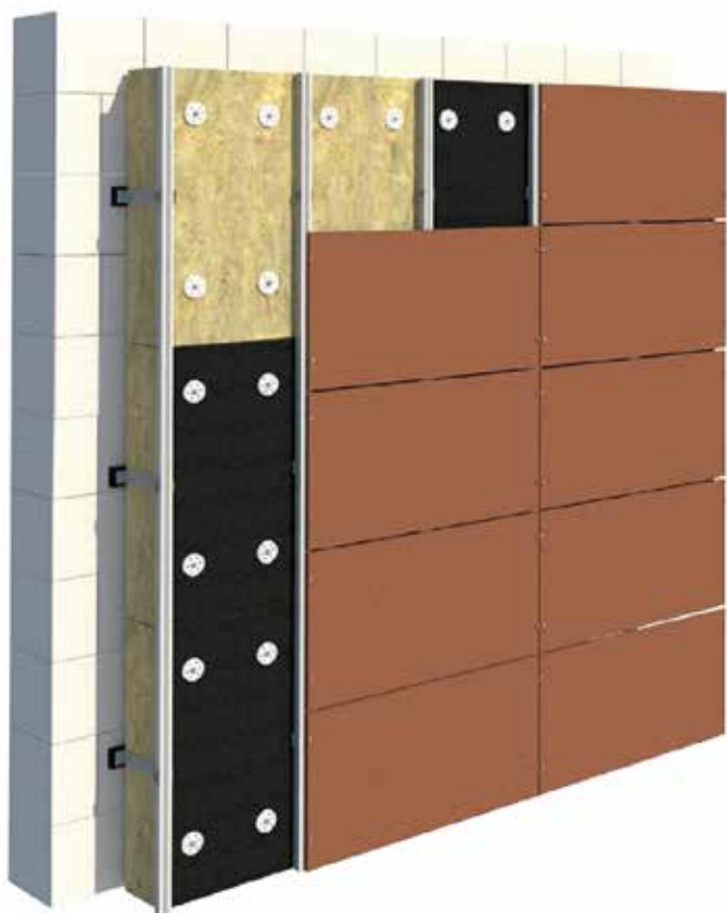
Jednotlivé vrstvy zateplovacího systému s čedičovou vlnou
