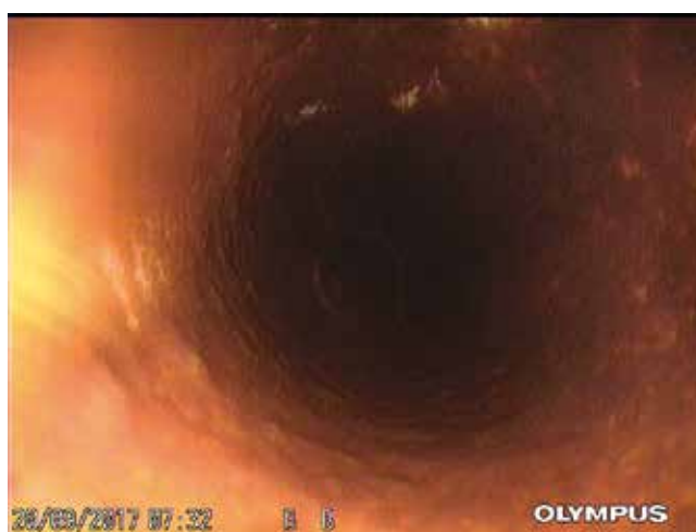
Foto z přímé realizace společnosti DK CHEMO s.r.o. z roku 2017: Vnitřní monitoring plastového rozvodu teplé vody po 8 letech provozu, v němž Legionella kolonizuje
